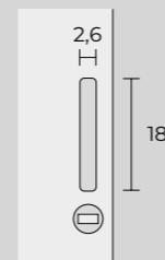
maniglia con blocco di chiusura handle with locking system
